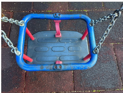
Siège nacelle présentant des risques car trop usé
