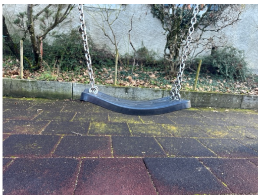
Siège anormalement déformé
