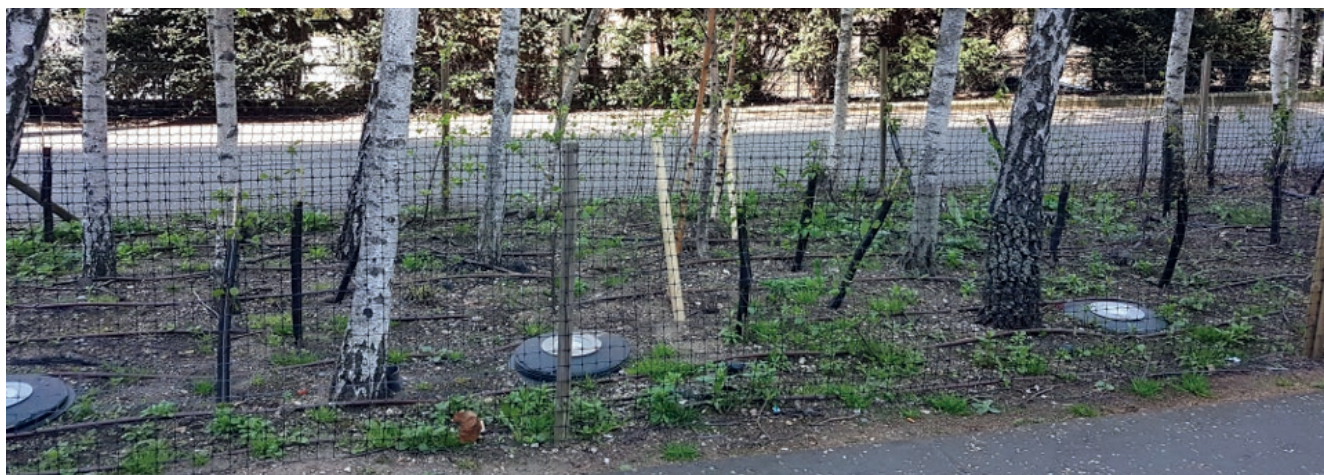
Espace plantable continu et perméable. L'installation d'une clôture permet de prévenir le tassement de l'espace racinaire. (© Atelier Nature et Paysage)
